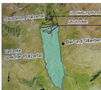
Der Platzertalspeicher nimmt 42 Mio. m 3 Wasser auf. Repro: Reichle
